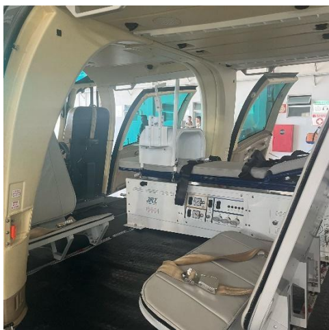
Helicóptero com maca e bancos de transporte de equipe instalados.
