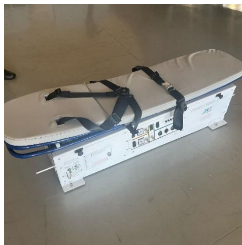
Maca para instalação na aeronave para transporte de dois enfermos.
